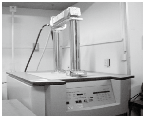
A: エックス線照射装置 PANalytical PW3830 for Transverse Microradiography
